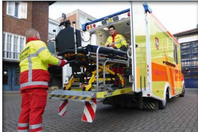
Zwei Rettungsassistenten der Feuerwehr entnehmen die elektrohydraulische Fahrtrage über die absenkbare Ladebordwand (Foto: Feuerwehr Hannover)
