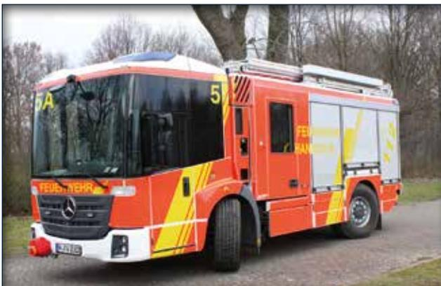
Das neue Hilfeleistungslöschfahrzeug HLF 20 der Feuerwehr Hannover auf einem Mercedes-Benz Econic 1830-Fahrgestell mit einem Aufbau von Magirus-Lohr erfüllt die Euro-6-Norm (Foto: Hasenberg)
