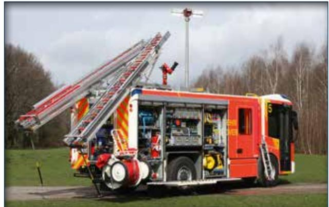
*Trotz Umsetzung von Euro 6 sind alle Geräteräume voll nutzbar. Auf dem Fahrzeugdach sind die tragbaren Leitern sowie ein Werfer untergebracht (Foto: Hasenberg)*
