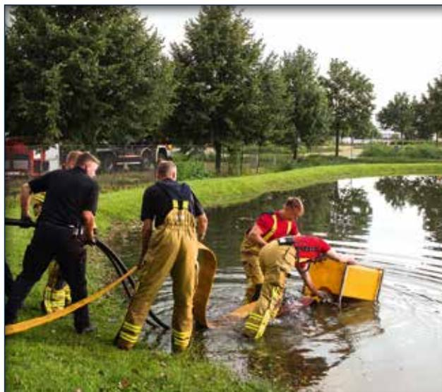
Mit dem Hochleistungs-Wasserfördersystem der Feuerwehr wurden pro Minute 6000 Liter Wasser abgepumpt (Foto: Elsner)
