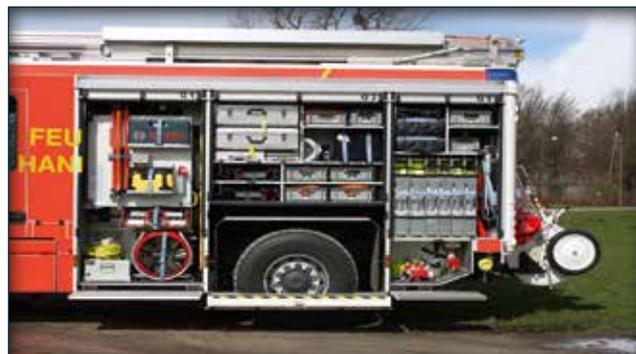
Hinter der Drehwand im Geräteraum 1 sind unter anderem ein Motortrennschleifer und ein Erdungsset der Deutsche Bahn AG gelagert (Foto: Hasenberg)
