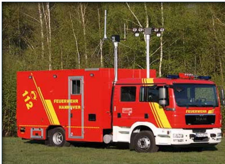
Betriebsbereiter GW-FüKom, Antennen- und Lichtmast werden pneumatisch ausgefahren (Foto: Hasenberg)
