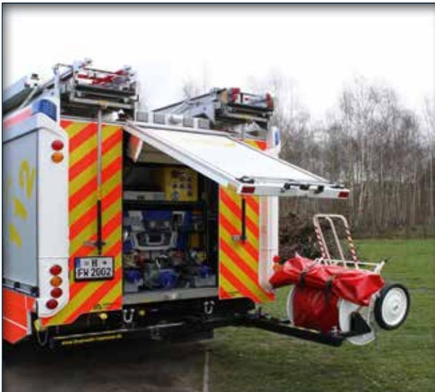
Im hinteren Geräteraum ist eine zweistufige Normaldruckpumpe FPN 10-3000 verbaut (Foto: Hasenberg)
