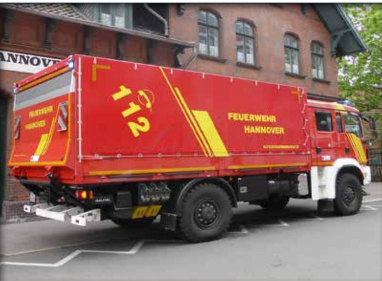
Am Heck des GW-Dekon P befindet sich eine Dautel-Ladebordwand die bis 1500 kg belastet werden kann (Foto: Feuerwehr Hannover)
