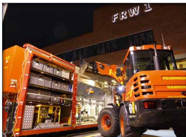
Präsentation einer Sandsackbefüllstation zur Gefahrenabwehr bei Hochwasserereignissen
