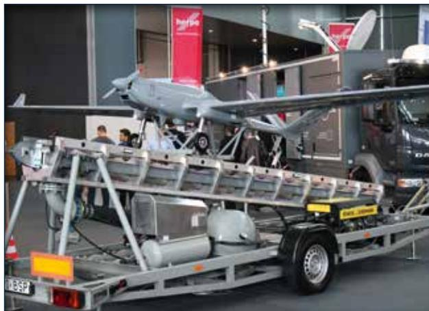
Im Vordergrund die Drohne des Proteus-Projektes auf mobiler Startrampe, dahinter ist das Mobile Command Center zu erkennen (Foto: Feuerwehr Hannover)
