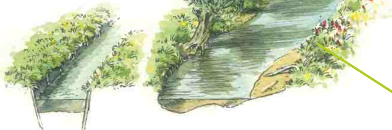
Durch den Einbau von sogenannten Flügelbuhnen wird die Strömung mal auf das eine, mal auf das andere Ufer gelenkt. Dies hilft der noch begradigten Ihme, ihren ursprünglich krummen Lauf wieder zu entwickeln.
