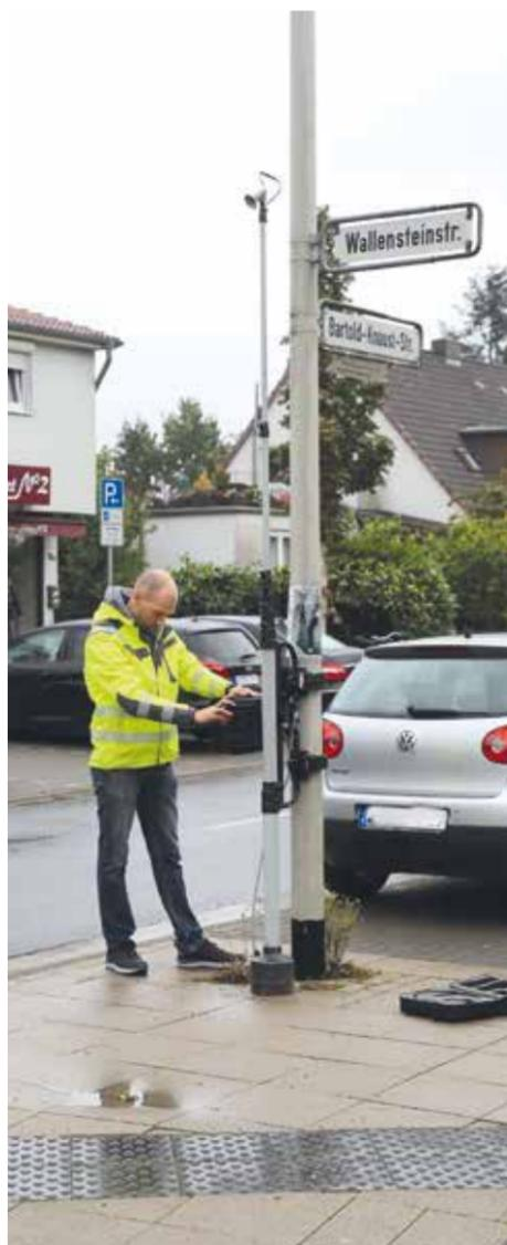
*Die Kamera wurde mit Hilfe einer Teleskopstange an einem Straßenschildmast angebracht. Sie filmte den gesamten Kreuzungsbereich so, dass auf den Aufnahmen weder Gesichter noch Kennzeichen zu erkennen waren. Stefan Thiele von SAP Ingenieure kontrollierte, ob die Aufnahme wie gewünscht lief und baute die Kamera nach einem Tag wieder ab. (Foto: Hoff)*
